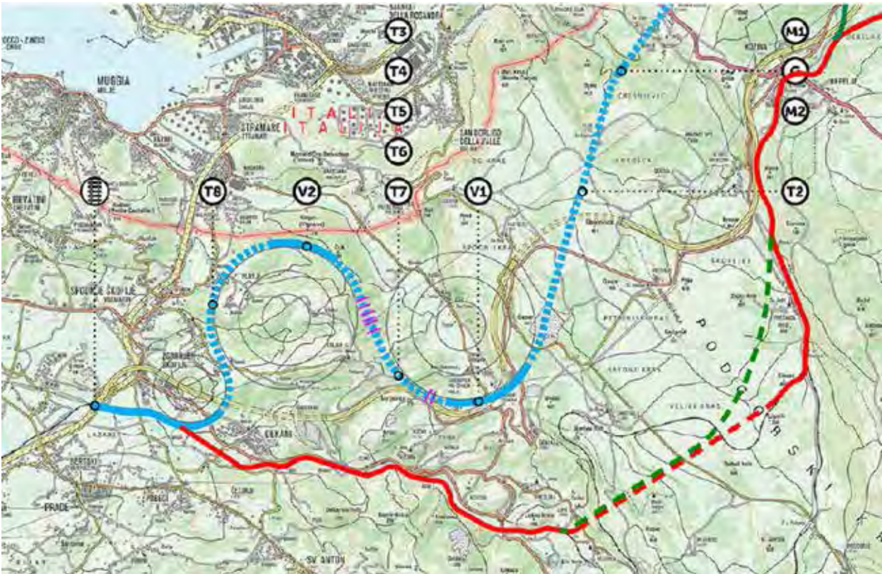
Slika 2: Groba trasa dvotirne proge v prostoru za primer uporabe težjih lokomotiv.
