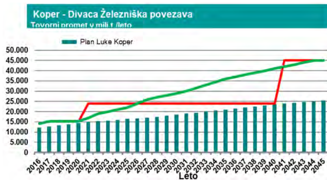
Slika 1: Plan pretovora v Luki Koper in črta zmogljivosti enotirne oziroma dvotirne povezave (rdeča barva).
